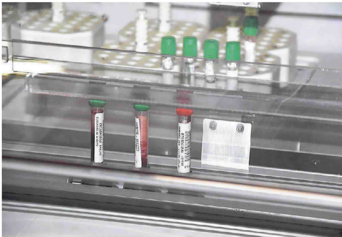
Il binario è lungo 28 metri e prevede 8 stazioni di analisi. Le provette viaggiano alla velocità di 1,5 metri al secondo
